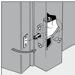
L'amortisseur se fixe avec trois vis par la cage de l'ascenseur dans l' huisserie de la porte, la tige en sortant par un perçage de 15 à 20 mm.
