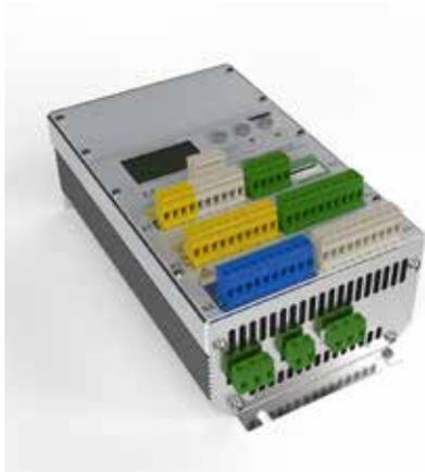
Le montage du contrôleur est très simple car le **module électronique peut être démonté** complètement avec sa plaque de montage du carter du contrôleur. Le couvercle du carter est aussi démontable. Il suffit de débrancher le câble plat. Maintenant le carter vide et léger est fixé au mur. De plus il n'y a aucun danger d'endommager l'électronique du contrôleur avec un tournevis ou autre.
